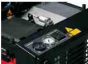
Panel de control con presión de aire, temperatura, contador de horas
